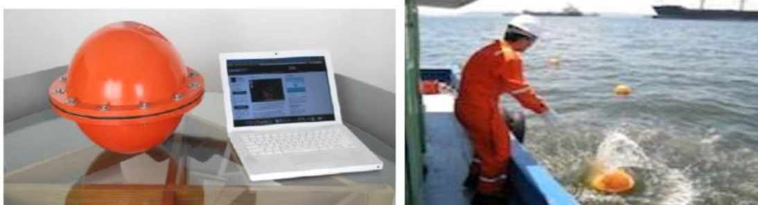
Figura 10: Boias de deriva ( drifting buoy ) (Fonte: Prooceano, 2013).
