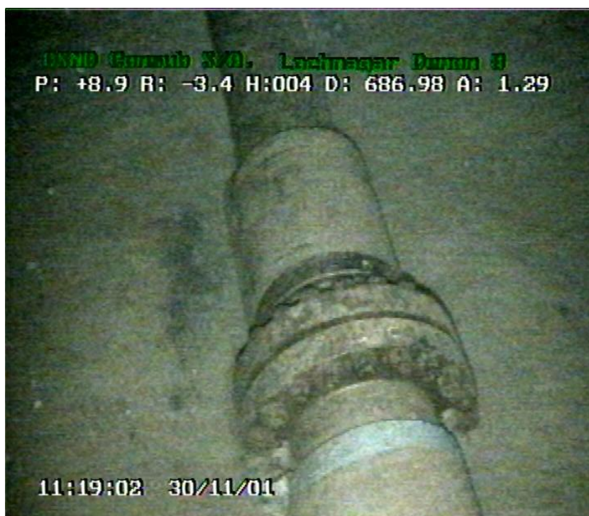
Figura 3.5-a. Imagem do gasoduto obtida com o ROV.
