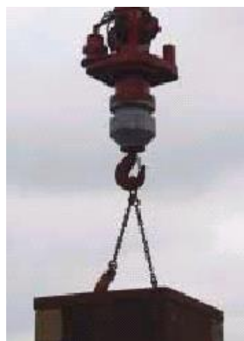
Figura 3.2.5-b. Sistema de alça do guindaste de braço articulado.
