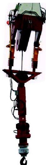
Figura 3.2.5-b. Sistema de alça do guindaste de braço articulado.
