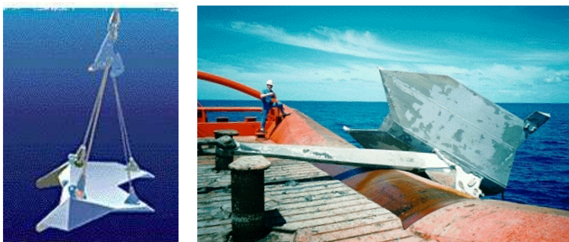
Figura 3.4.5-a. Âncora em gancho VLA utilizada no sistema de ancoragem do FPSO.
