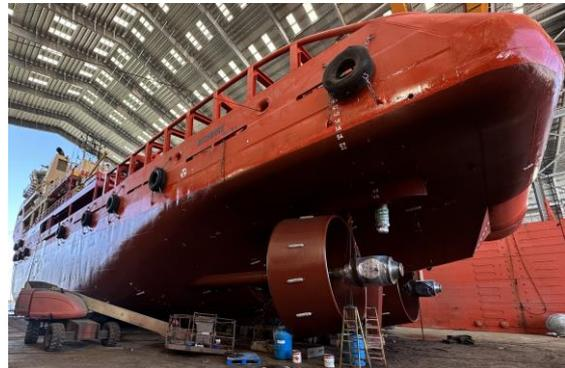
**Foto 8** – Costado de bombordo, alheta, fundo do casco junto à popa e propulsor principal de bombordo. Tinta aplicada e áreas isentas de macroincrustações.
