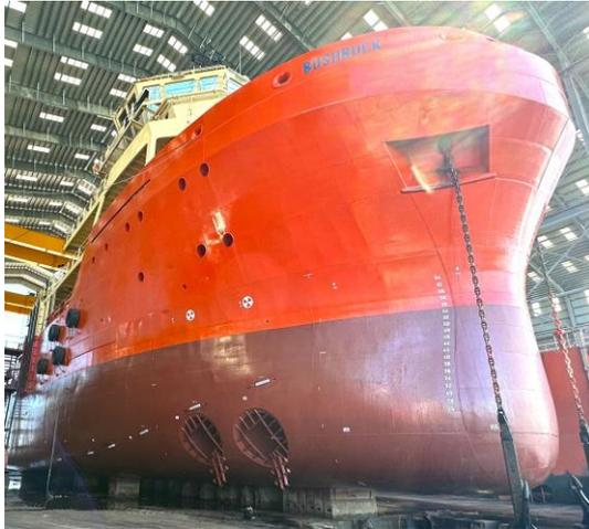
**Foto 1** – Proa pelo boreste, costado junto à proa a grades dos thrusters de proa. Casco limpo e tinta aplicada, isento de macroincrustações.
