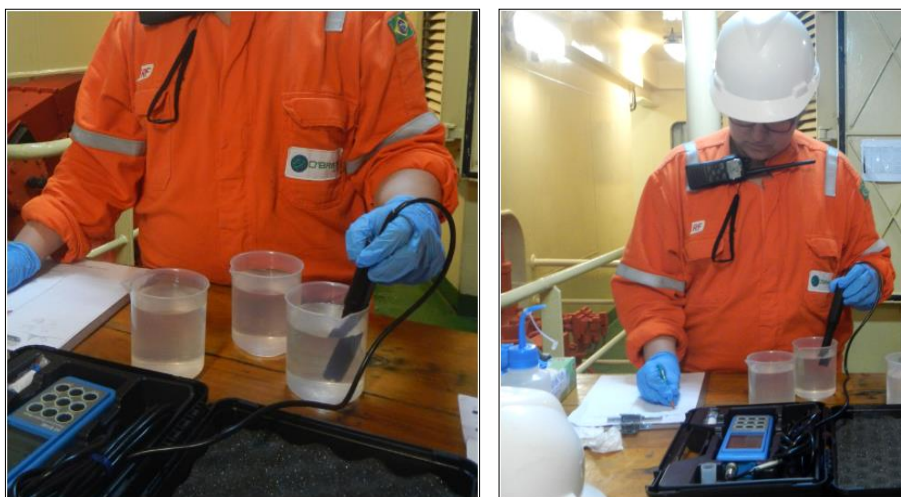
Figura 7: Equipamentos utilizados na medição dos parâmetros físico-químicos in situ e na filtração durante a 9ª campanha de Monitoramento Ambiental do Parque das Conchas, Bacia de Campos.
