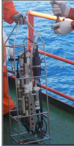
Figura 5: CTD utilizado durante a 9ª campanha de Monitoramento Ambiental do Parque das Conchas, Bacia de Campos.
